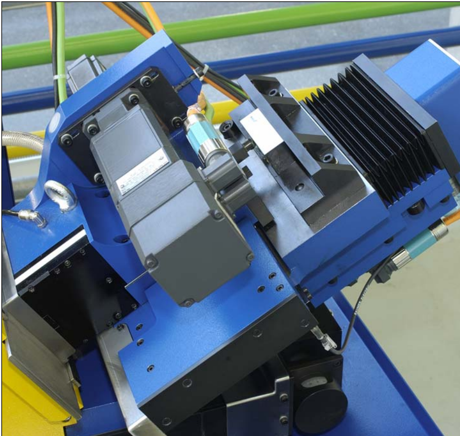
Automatisches Abrichten der Schleifscheibe
