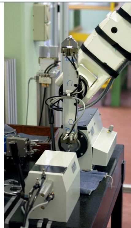
3 Mittels Post-Process-Messung wird die Einhaltung der Qualitätskriterien belegt. R_a -Werte von 0,4 und Genauigkeiten von zwei Mikrometern sind dabei Standard
