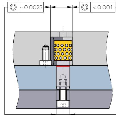
Grâce aux éléments roulants, les plaques à installer peuvent être montées facilement, sans jeu et sans à-coups – peu ou pas de connaissances spécialisées sont nécessaires pour cela. Dans de nombreux cas, ces plaques fabriquées de manière complexe nécessitent un entretien fréquent ; grâce au système d'éléments roulants, l'entretien peut être effectué rapidement et en douceur – la station de changement rapide est souvent utilisée pour une production flexible.
