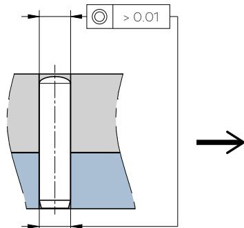
**Centraggio:** Le serie standard 7990/3, centraggio multiplo e 798x sono particolarmente indicate per centraggi «**dinamici**». Il centraggio dinamico è un centraggio continuo di spesso 2 unità cubiche, spesso singole piastre o sovrastrutture. All'interno di un ciclo ricorrente, queste piastre sono centrate senza gioco dai centraggi Agathon.
